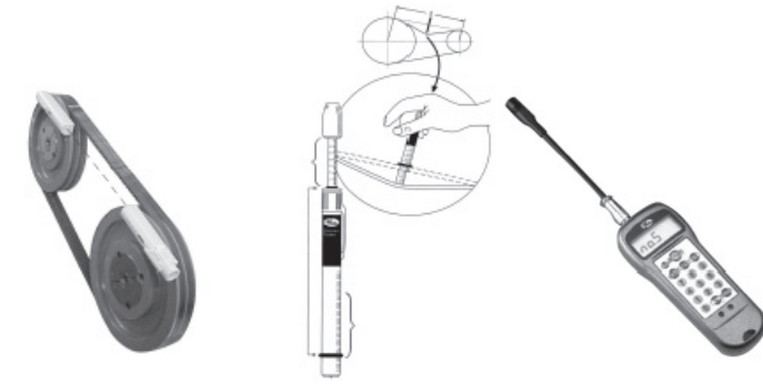
תמונה 1- מודד אקוסטי תמונה 2- מד כוח תמונה 3- מד שיבור לייזר
